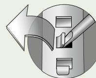
Bloqueo mediante sistema FAS con destornillador
