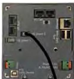
Se pueden conectar hasta cuatro BMV directamente al Color Control. Se pueden conectar incluso más BMV a un concentrador USB para llevar a cabo una monitorización centralizada.
